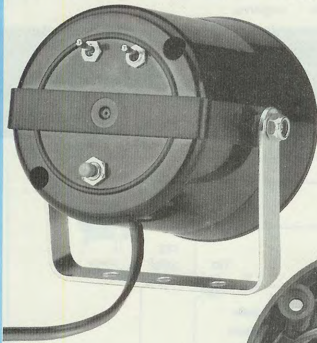
Fig.3 Sulla calotta posteriore della tromba esponenziale dovreste applicare i due deviatori ed il pulsante, mentre al suo interno dovreste fissare con due distanziatori autoadesivi il circuito stampato (vedi foto sotto).
