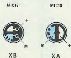
Fig.9 Sul retro del microfono preamplificato, potreste trovare queste due diverse piste per il collegamento del filo schermato. Come noterete, la pista di "massa" è sempre collegata elettricamente alla carcassa metallica del microfono. La calza esterna del cavetto schermato andrà collegata sempre a tale pista.
