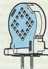
Fig.1 Foto della mascherina frontale serigrafata e del sensore Philips utilizzato per la realizzazione di questo igrometro.
