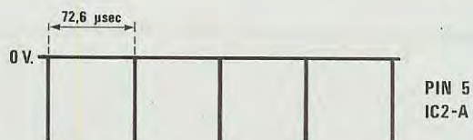
Fig.2 Dal piedino d'uscita 5 dell'integrato siglato IC2/A utilizzato come oscillatore stabile (vedi fig.6), usciranno degli impulsi negativi strettissimi, che andranno utilizzati per pilotare il piedino 8 del monostabile siglato IC2/B. Questi due integrati sono contenuti all'interno di un NE.556.
